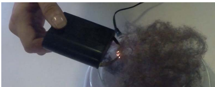
Obr. 5 Okamih zapálenia Joulovým teplom
