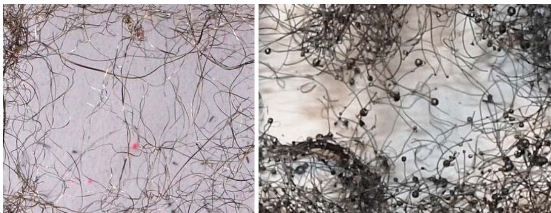
Obr. 9 Makrofotografia ocelevej vlny pred a po zhorení
