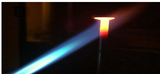
Obr. 1 Pokus o zapálenie železného klinca
