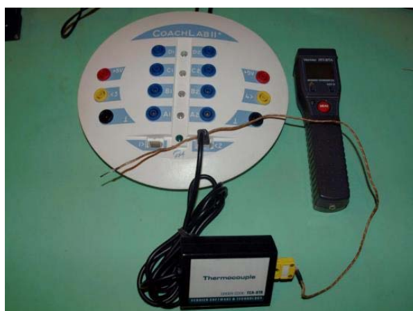
Obr. 6: Meranie teploty v ohnisku šošovky pomocou termočlánku a meracieho panelu Coach alebo infračerveného teplomera
