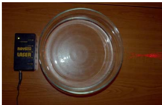
Obr. 3: Zväzok laserových lúčov prechádzajúcich hrubou šošovkou zbiehajúci sa do jedného bodu
