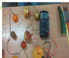
Obr. 4 Vytváranie elektrických obvodov z ovocia a zeleniny (zdroj: vlastné spracovanie)
