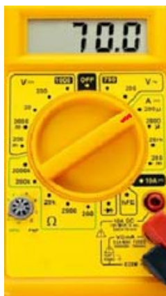
Obr. 3: Odčítanie hodnoty z displeja digitálneho ampérmetra s prepínačom rozsahu.
