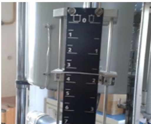
Obr. 2: Odčítanie hodnoty z jednoduchej stupnice s dôrazom na uvedenie neistoty merania a jednotky meranej veličiny.
